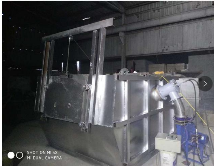
LRF-3T մակնիշի ձուլման վառարան
