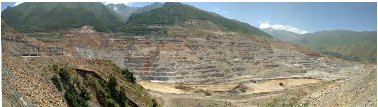
Լուսանկար 3. «Զանգեզուրի պղնձամուլիբդենային կոմբինատ» ՓԲԸ-ի կողմից շահագործվող Բացհանքի լեռնահատկացման տարածքում բացված դարավանդաձև կտրվածքները
