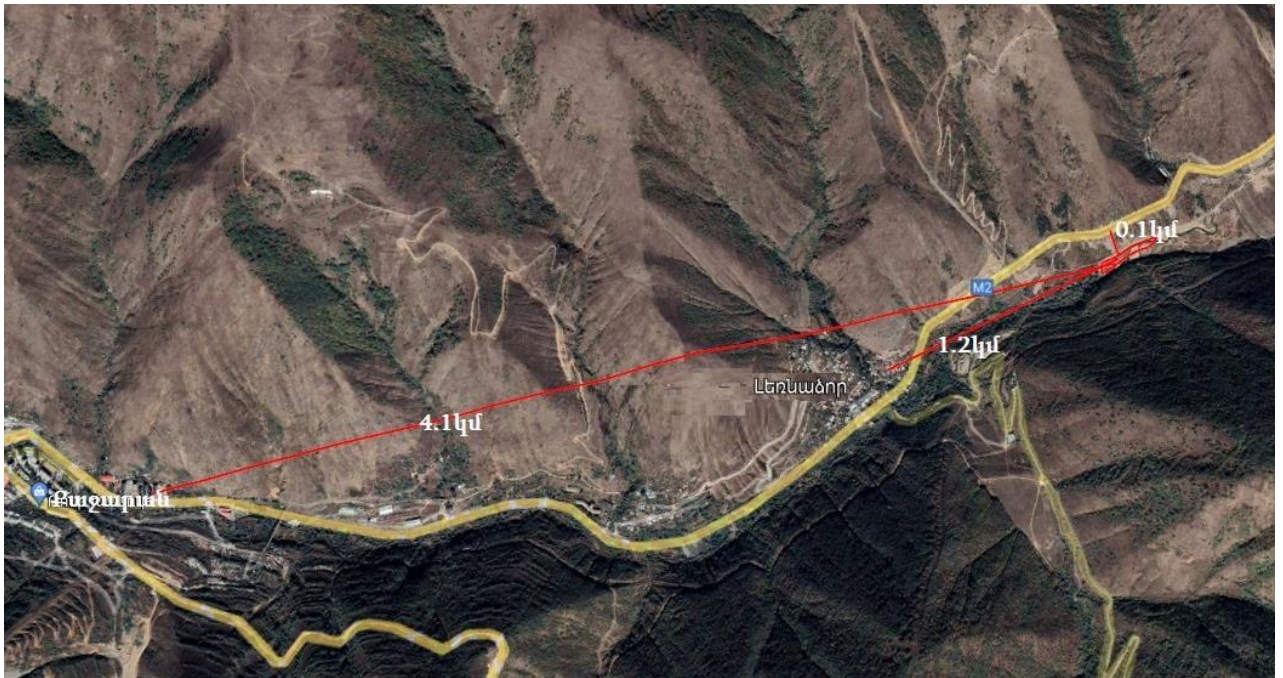
Նկար 17. Նախագծվող տեղամասի հեռավորությունը մոտակա զգայուն կլանիչներից Ք. Քաջարան 4.1կմ Գ. Լեռնաձոր 1.2կմ Մ-2 Կապան-Մեղրի մայրուղի 0.11կմ գ. Ողջի 10-12մ
