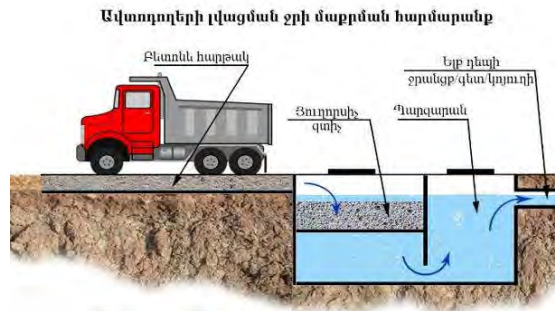
Գծապատկեր 1. Ավտոդողերի լվացումից առաջացած ջրի մաքրման կառուցվածք
