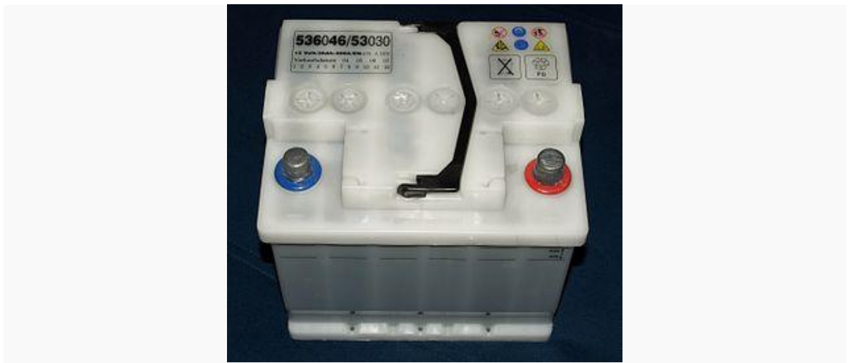
Նկար 5. Ավտոմեքենաների կապար-թթվային մարտկոց
