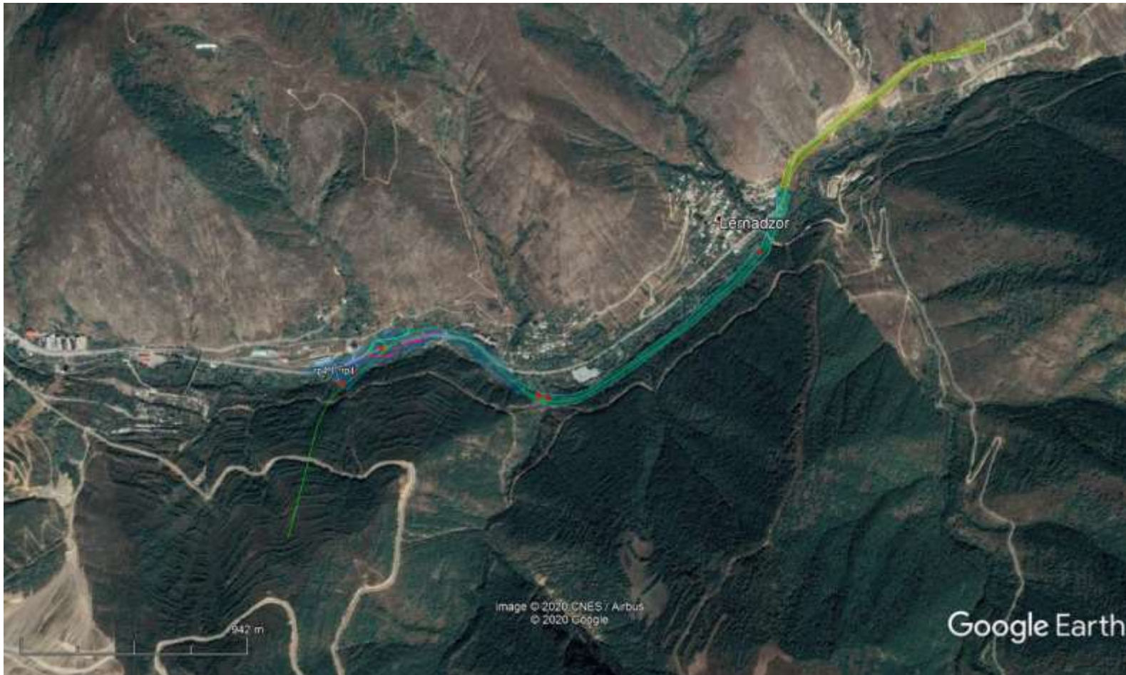
Պատկեր 27: Հս-Հր ավտոմայրուղու ծրագիծը Լեռնաձոր գյուղի հատվածում մինչև թունելի մուտքը Google Earth ծրագրի լուսանկարում: Դեղինով սահմանագծված է վերակառուցվող ճանապարհի հատվածը մինչև Լեռնաձոր գյուղը, բաց կապույտով Լեռնաձոր գյուղի շրջանցման հատվածը-A (կաղնու և բոխու գերակշռությամբ սաղարթավոր անտառ –A), մուգ կապույտով սահմանագծված է ավտոմայրուղու Լեռնաձոր – թունելի մուտք-Քաջարան խաչմերուկը (բարձրլեռնային գետահովիտային Էկոհամակարգ -B).
