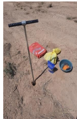
ձեռքի հատուկ հորատիչ գործիք՝ հողանմուշարկման համար
