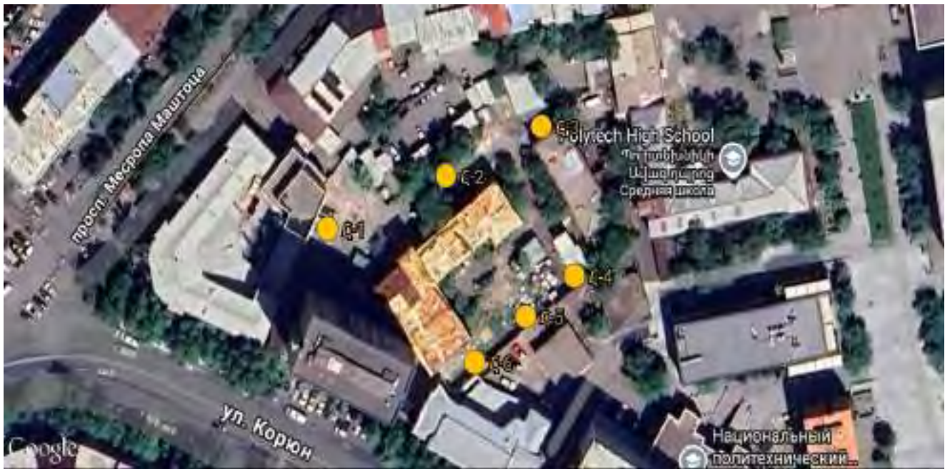
Գծանկար 5. Տեղամասի հորատանցքերի տեղաբախշման սխեմատիկ քարտեզ
