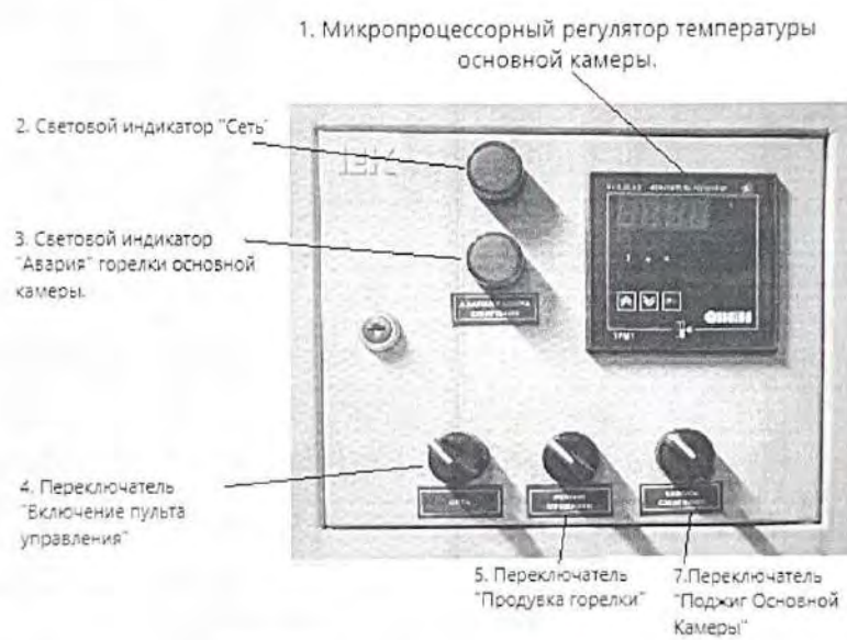
Рисунок 4.1 – Пример панели управления инсинератором (Тип1) одnogорелочный.
