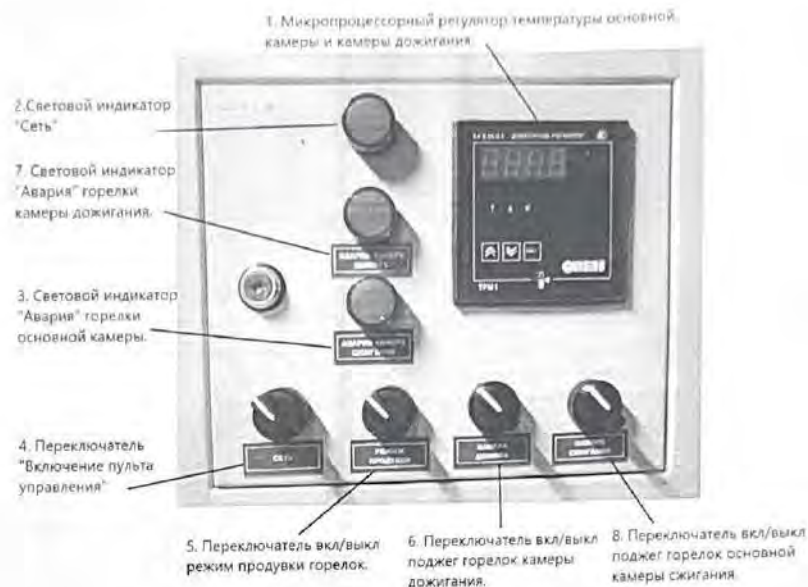
Рисунок 4.2 – Пример панели управления инсинератором (Тип 2) мульти горелочный. Описание основных элементов и назначение индикаторов.
